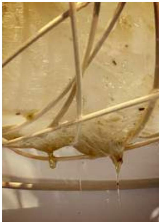
branas permite transmitir las microtensiones estructurales de mismo modo que como material constructivo tradicional y popular permitía transmitir las tensiones a la escayola gracias a sus fibras, generando un material constructivo resistente donde la escayola no era capaz, por si sola, de cumplir los requerimientos mecánicos fruto de las solicitudes estructurales. Podríamos hablar, por tanto, de que en algunas de las piezas cumple esta doble función, tanto poética como estructural.
